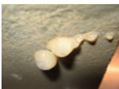
Abb. 1: Typische Beispiele für Biofilmentwicklung auf ungeeigneten Werkstoffen im Trinkwasserkontakt
